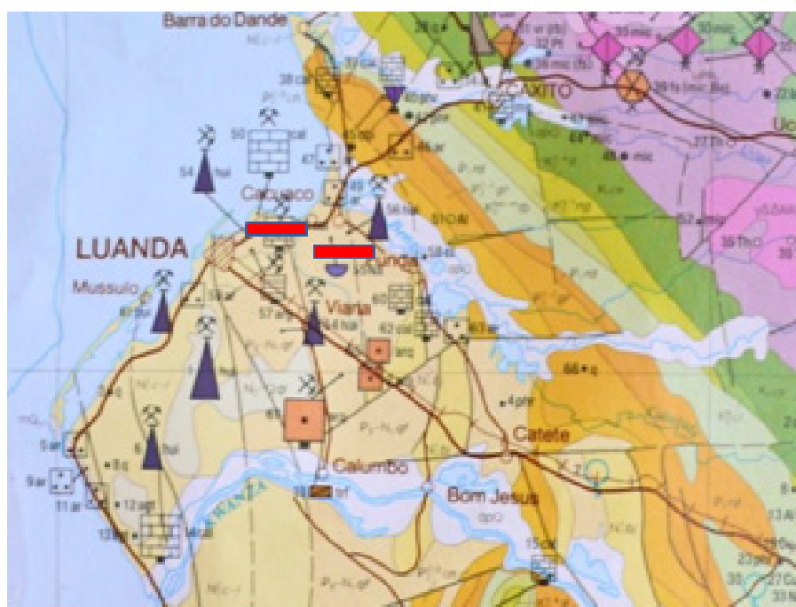
Figura 1: Mapa geológico da região de Luanda. As jazidas de calcário e argila disponíveis são utilizadas no fabrico de clínquer/CPO pelas fábricas instaladas na zona. Fonte: Serviço Geológico Nacional.
