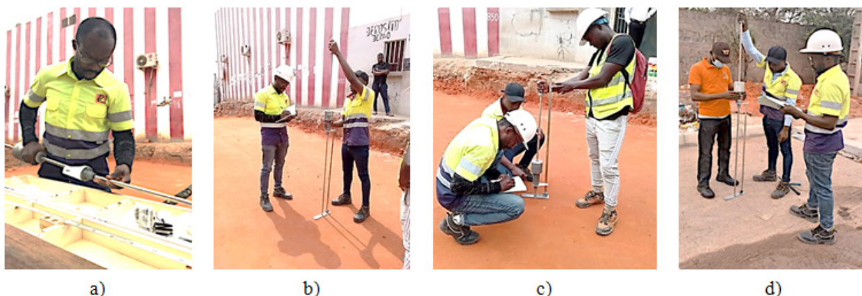
Figura 18- Ensaios de campo com DCP; a) montagem do equipamento, b) posicionamento, c) Registo da Leitura na camada de sub-base, d) registo de leitura na camada de base
