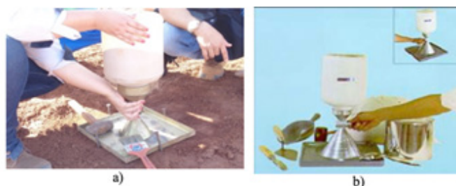
Figura 3 -Garrafa de Areia; a) posicionamento no solo; b) equipamento e utensílios
