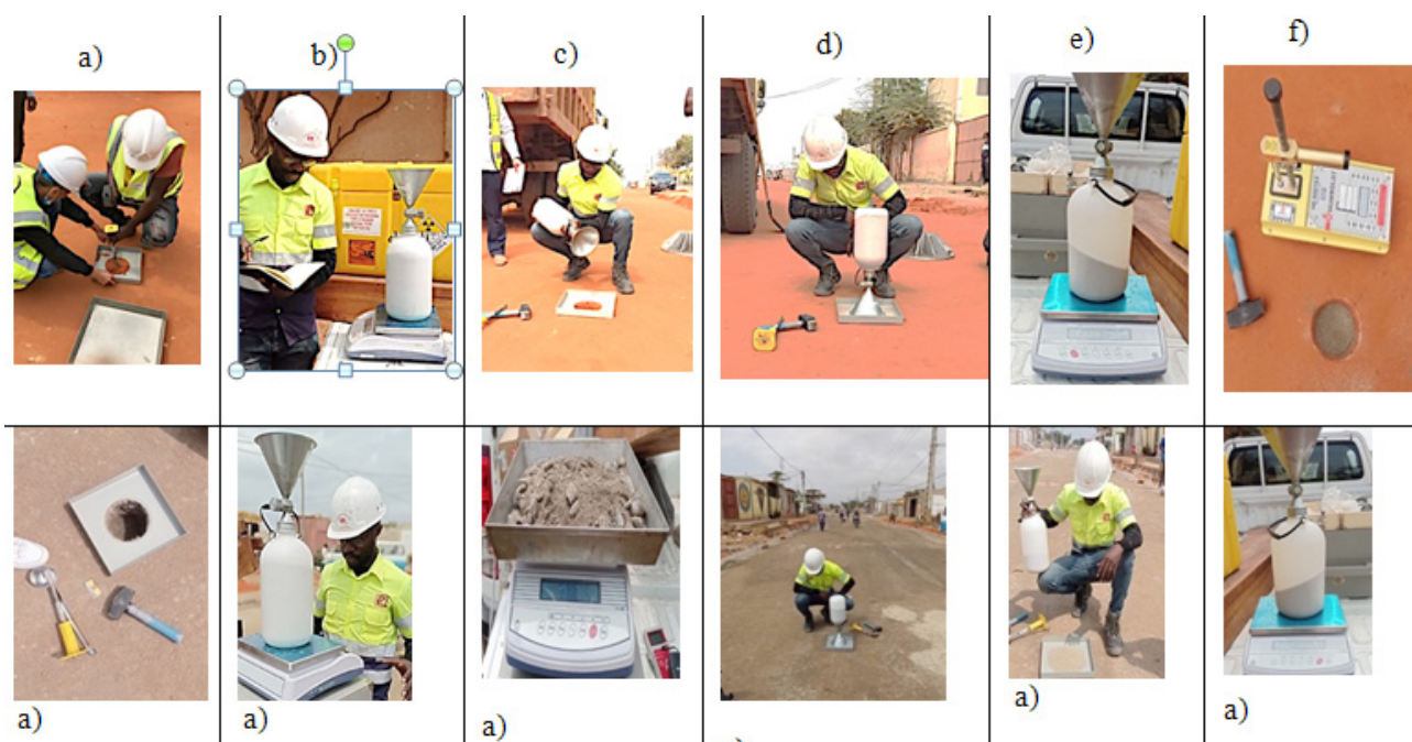
Figura 17- Ensaios de campo com Garrafa de areia da camada de solos; a) abertura do orifício, b) pesagem antes de a colocar no orifício, c) Colocação do funil na placa, d) queda da areia, e) pesagem depois de retirá-la do orifício, e) determinação do teor em água. Ensaios de campo com a Garrafa de areia da camada de ToutVenant; a) abertura do orifício de ensaio, b) pesagem da garrafa antes de a colocar no orifício, c) pesagem do material húmido, d) preenchimento do orifício com areia, e) retirada da garrafa, e) pesagem depois da garrafa depois de retirá-la do orifício de ensaio.
