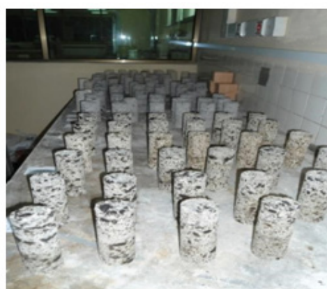
Figura 5 Mistura preparada (à direita). Figura 5.1 (Esquerda) Espécimes cilíndricos prontos para testes de compressão.
