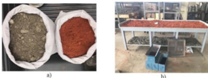
Figura 6-Amostragem; a) Amostras recolhidas; b) Secagem ao ar livre, esquadrelador e malhas ¾ e 4
