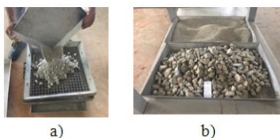
Figura 9-a)Peneiração; b) separação da fração grossos e finos
